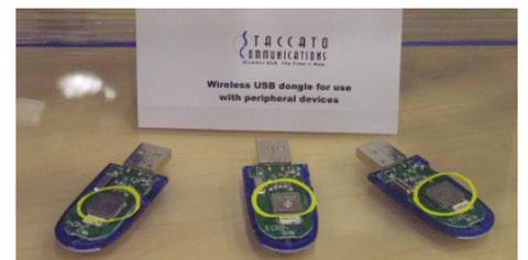
**Prototypes d'adaptateurs USB transformant un périphérique USB en un appareil WUSB.**
