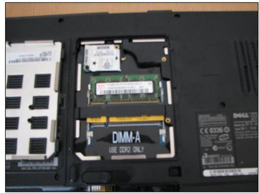
4. Si vous remplacez un module de mémoire, écartez avec précautions les pinces de fixation situées à chaque extrémité du connecteur du module de mémoire jusqu'à ce que le module sorte. Retirez alors le module du connecteur.
